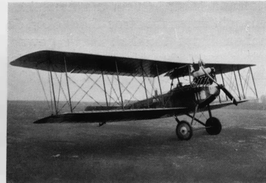
Der Albatros-Doppeldecker B II als Landflugzeug mit dreistieliger Zelle. Es ist beachtenswert, wie Ernst Heinkel schon damals die auch heute noch bestehende Forderung nach der Angleichungsmöglichkeit ein- und derselben Maschine an verschiedene Zwecke zu berücksichtigen wußte. 1914
