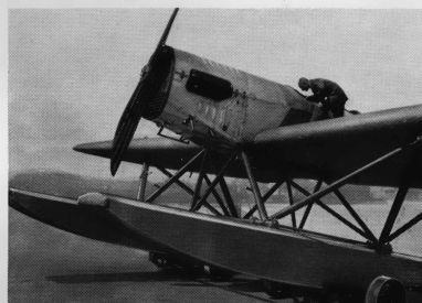
Halbfreitragender Heinkel Hochsee-Tiefdecker He 5, mit dem Herr von Gronau im Seeflugwettbewerb Warnemünde den 1. Preis gewann 1926
