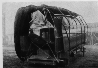
Albatros - Zweidecker B I 1913, auf Kraftwagenanhänger verladen, bei einer Übung in Döberitz
