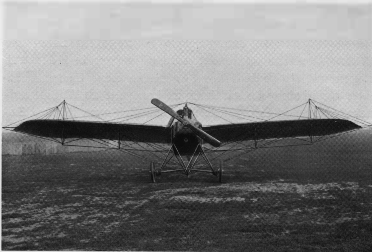
Bei Albatros unter Ernst Heinkels Leitung erbaute Taube (Brücken-Konstruktion mit Fournierrumpf). 1913
