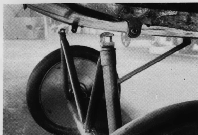
Fahrwerks-Anschluß des Tiefdeckers He 3 mit karabinerartig ausgebildeten Beschlägen 1923
